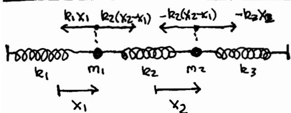
$$\begin{bmatrix} m_1 \ddot{x}_1'' \\ m_2 \ddot{x}_2'' \end{bmatrix} = \begin{bmatrix} -(k_1+k_2) & k_2 \\ k_2 & -(k_2+k_3) \end{bmatrix} \begin{bmatrix} \dot{x}_1 \\ \dot{x}_2 \end{bmatrix} + B_0 \cos \omega t \begin{bmatrix} 0 \\ 1 \end{bmatrix} - \begin{bmatrix} e_1 \\ e_2 \end{bmatrix} \begin{bmatrix} x_1' \\ x_2' \end{bmatrix}$$
